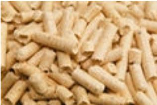
Holzpellets werden aus getrocknetem und gepresstem Sägemehl hergestellt, haben eine minimale Restfeuchte und einen Aschegehalt von unter 0,5 %. Sie kommen in vollautomatischen Pelletszentralheizungen und Pelletsöfen zum Einsatz und sind die bequemste Art mit Holz zu heizen. 1 Tonne Holzpellets ersetzen 500 Liter Heizöl und bieten den gleichen Heizkomfort!
